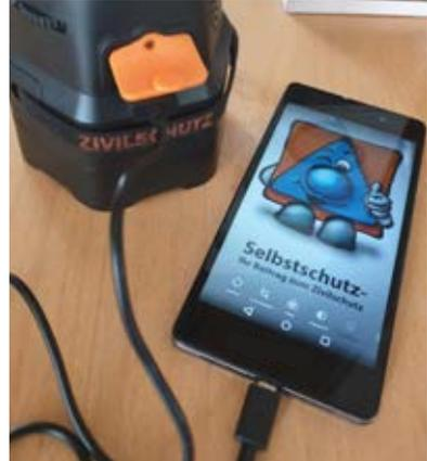
Das Notfallradio soll strom- und batterieunabhängig sein, Geräte mit einem Dynamo- bzw. Kurbelantrieb ersparen die Batterie-Bevorratung.
